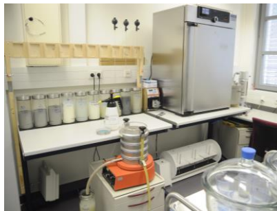
Apparate zur Auftrennung von Bodenproben nach Korngrößen.
