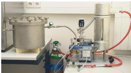
Abb. 1: Apparatur zur Dampfequilibration
