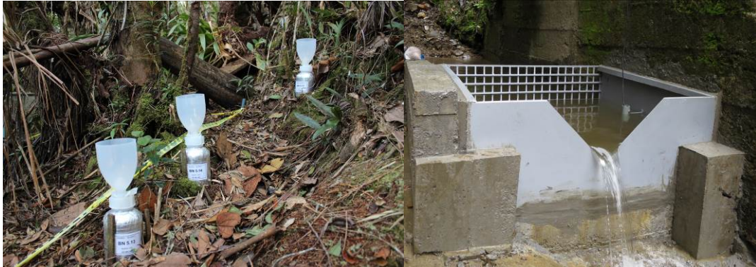
Messung von Bestandesniederschlag und Abfluss in einem Kleineinzugsgebiet.
