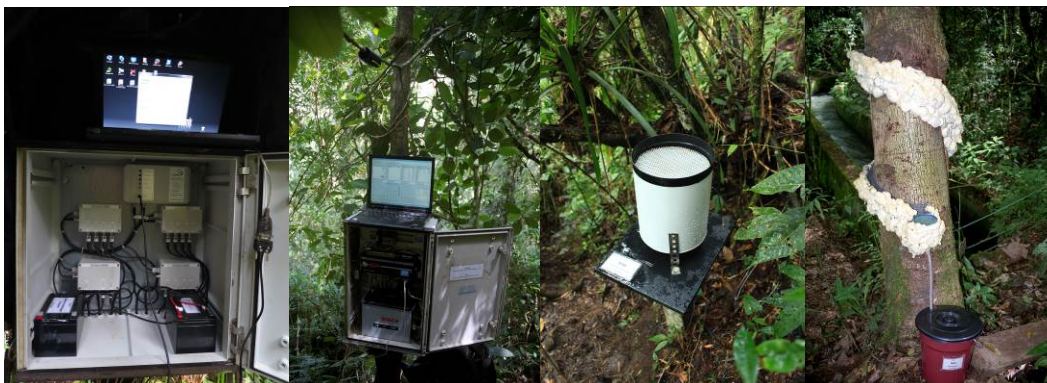
Messinstrumente zur Erfassung von Matrixpotential, Bodenfeuchte, Niederschlag und Stammablauf.
